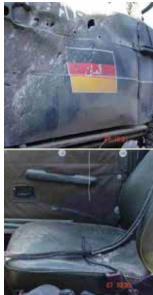
ስዕል 2.1 ከመኪና ውስጥና ውጭ የሚገኝ የባልስቲክ ብርድልብስ ውጤት። በመኪናው የውስጥ ክፍል ምንም አይነት ፍንጣራ አልተገኘም።
